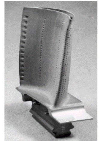
単結晶合金TMS-138 高圧タービン翼
